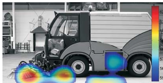
📷 „Akustische Fotografie“ einer Reinigungsmaschine
